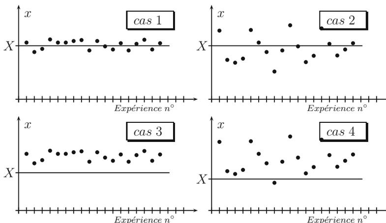
Le cas 1 présente une faible erreur aléatoire (instrument fidèle) et une faible erreur systématique (instrument juste). Dans le cas 2 l'instrument de mesure est peu fidèle mais juste, dans le cas 3 il est fidèle mais peu juste et dans le cas 4 il est peu fidèle et peu juste.
