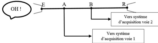
Deux capteurs, reliés en deux points A et B distants de  $D = 20$  m sur le fil, détectent successivement le passage d'une perturbation générée par un son bref à l'entrée du pot de yaourt émetteur E.
