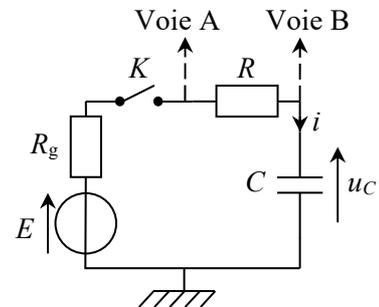
Dans l'étude expérimentale du circuit  $RC$ , on observe l'oscillogramme ci-dessous, en utilisant un générateur délivrant des signaux en créneaux.
