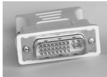
Fig. 2.6 – Prise DVI (convertisseur DVI/VGA)
