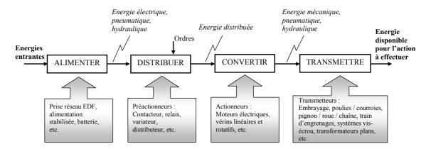
Pour des raisons de sécurité, l'énergie issue de la chaîne d'information est faible, et n'est pas suffisante pour être utilisable directement par les actionneurs.
