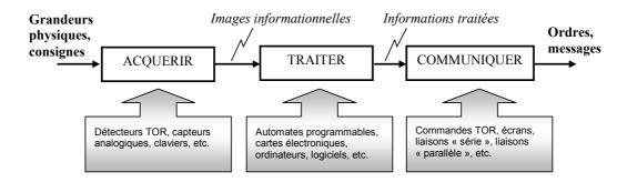
Pour acquérir une grandeur physique (force, température, etc.) ou une consigne, les constituants utilisés sont des capteurs. Ils restituent une grandeur image sous forme logique, numérique ou analogique exploitable par l'unité de traitement.
