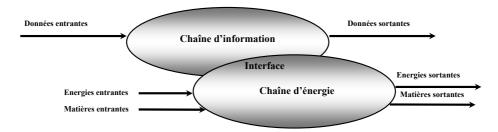
➡ Méthode 1.2. Détermination des données, des énergies et des matières entrantes et sortantes associées à la chaîne d'information et à la chaîne d'énergie
