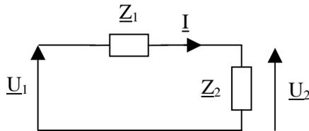
$$\underline{U}_2 = \underline{Z}_2 \underline{I} \text{ avec } \underline{I} = \frac{\underline{U}_1}{\underline{Z}_1 + \underline{Z}_2}$$
