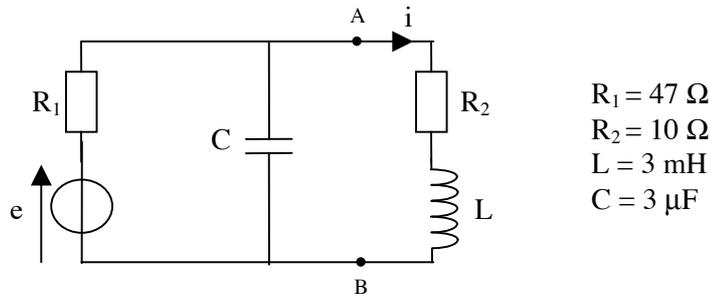
1. Déterminer le modèle de Thévenin ( $\underline{E}_{th}$ ,  $\underline{Z}_{th}$ ) équivalent au dipôle AB.
