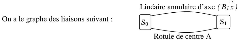
Le torseur des actions mécaniques transmissibles entre  $S_1$  et  $S_0$  s'écrit au centre A de la liaison rotule:  $[S_1 \xrightarrow{1} S_0] = \begin{Bmatrix} X_A & 0 \\ Y_A & 0 \\ Z_A & 0 \end{Bmatrix}$ .
