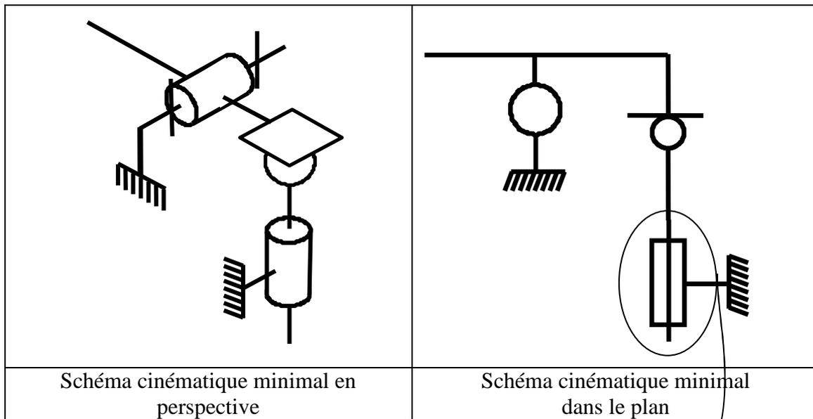
Si on néglige la rotation du piston dans le bâti, on obtient les hypothèses nécessaires à une étude plane. La liaison pivot glissant devient une liaison glissière. Le schéma devient alors :
