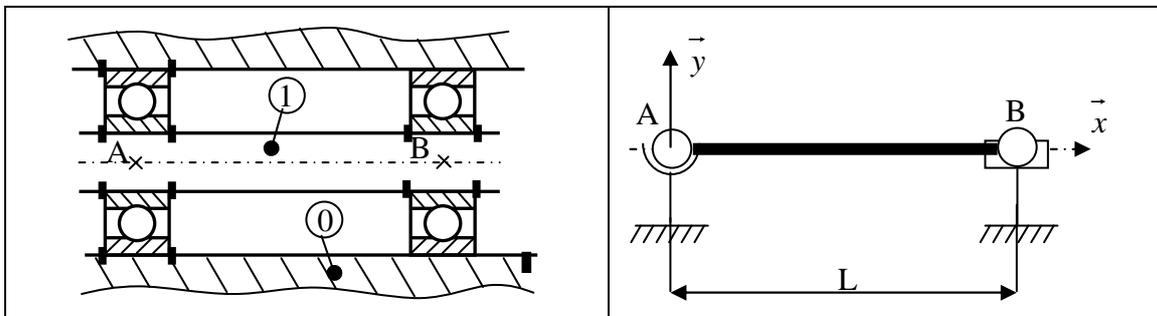
On considère le guidage en rotation d'un arbre par deux roulements à billes. Compte tenu des arrêts axiaux, et du jeu dans les roulements, on modélise le roulement en A par une liaison rotule et le roulement en B par une liaison linéaire annulaire.
