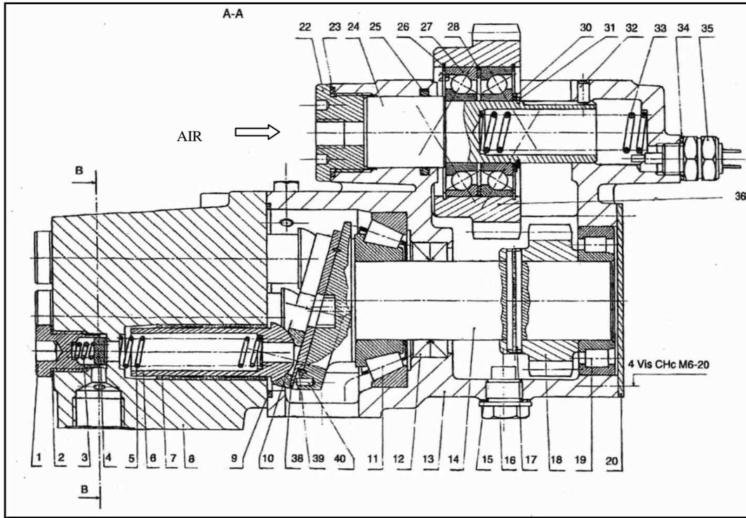
L'admission se fait par une glace de distribution plane **38** comportant une lumière semi-circulaire permettant le passage du fluide à travers la coupelle **10** et le piston **6**. Le refoulement se fait par un clapet **4**.
