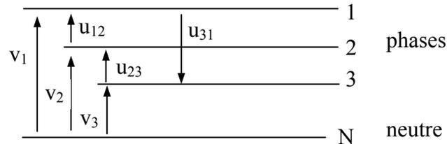
Le système est composé de trois phases et d'un neutre.
