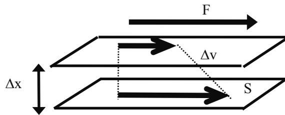
On admettra la définition du coefficient de viscosité, selon le schéma ci-dessus
