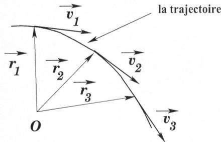
FIGURE 1.1 – Trajectoire d'un point matériel. Le vecteur vitesse évolue avec le temps.
