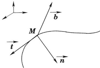
FIGURE 1.3 – Trièdre de Frenet. Les trois vecteurs sont : le vecteur tangent  $\mathbf{t}$ , le vecteur normal  $\mathbf{n}$  et le vecteur bi-normal  $\mathbf{b}$ .
