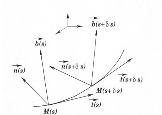
FIGURE 1.4 – Variation infinitésimale du trièdre de Frenet au cours du mouvement.
