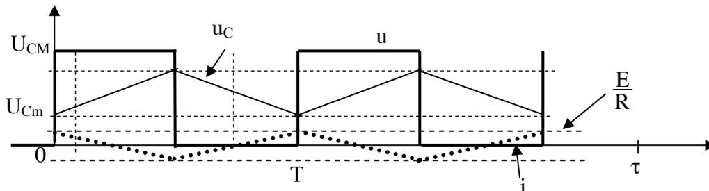
Réponse en courant et tension d'un circuit RC à une attaque en créneau
