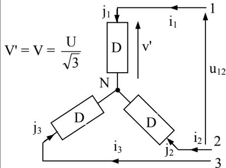
En étoile, chaque dipôle est soumis à la tension simple  $v'$  et est traversé par le courant par phase  $j$  égal au courant en ligne  $i$ . Soit  $Z$  l'impédance de chaque dipôle D.
