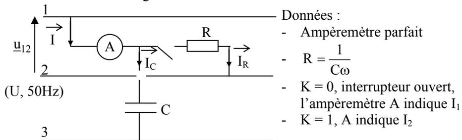
Figure 1 : Schéma de détecteur d'ordre des phases
