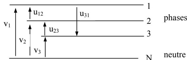
Le système est composé de trois phases et d'un neutre  $N$ .
