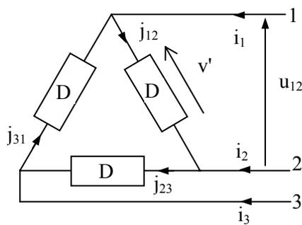
En triangle, chaque dipôle est soumis à la tension composée  $u$  et est traversé par le courant par phase  $j$ . Il n'y a pas de neutre dans le couplage triangle.
