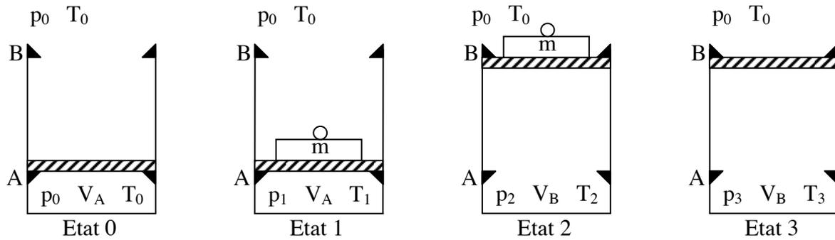
On place une masse  $m$  sur le piston et on chauffe très doucement le gaz par un moyen approprié, non représenté sur le schéma, jusqu'à ce que le piston décolle de la cale A. (gaz dans l'état 1 :  $P_1, V_A, T_1$ )
