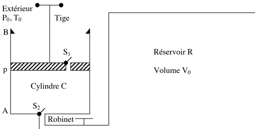
**49)** Dans l'état initial, le piston est en B, le cylindre et le réservoir contiennent de l'air à la pression atmosphérique  $P_0$  et à la température  $T_0$ . On pousse le piston jusqu'en A exactement contre le fond (on considère qu'ici  $V_A = 0$ ) et on le ramène en B assez lentement pour que la température reste  $T_0$ . Expliquer les différents transferts de gaz au cours de cet aller-retour.
