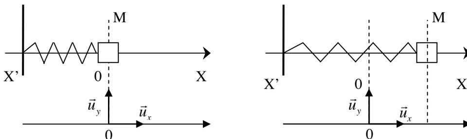
M est fixée à l'extrémité d'un ressort de raideur  $k$  dont l'autre extrémité est fixe dans  $\mathfrak{R}$ . La position de M est repérée par son abscisse  $x$ .  $x=0$  correspond au ressort détendu.
