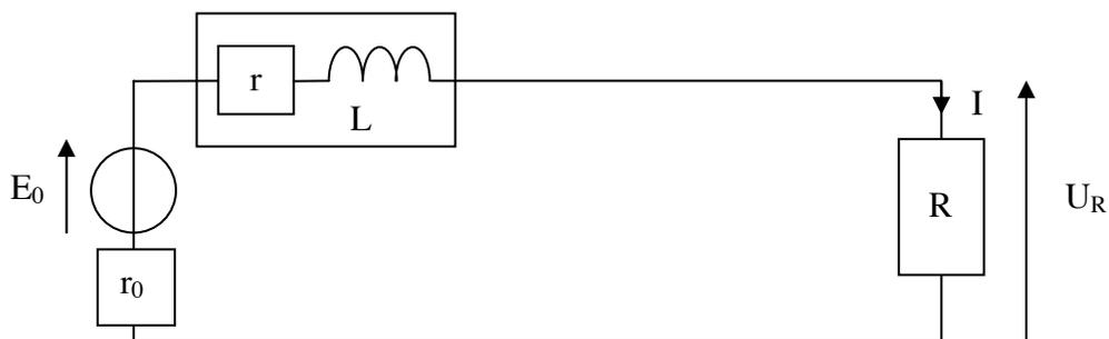
On mesure, en régime permanent, la tension  $U_R$  aux bornes de  $R$ . Exprimer  $r$  en fonction des données de cette question. Calculer  $r$  avec  $U_R = 0,56\ \text{V}$ .
