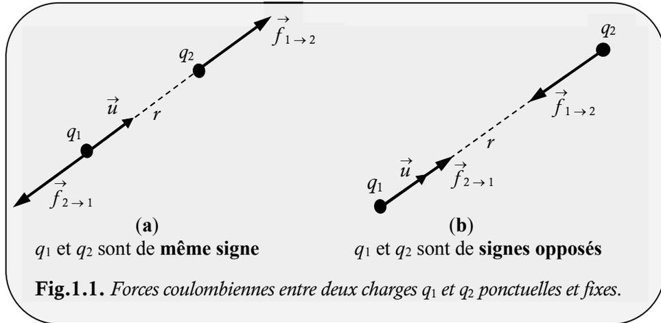
• En vertu de la loi de Coulomb, la force  $\vec{f}_{i \rightarrow j}$  exercée par la charge  $q_i$  sur la charge  $q_j$  est égale et opposée à la force  $\vec{f}_{j \rightarrow i}$  exercée par la charge  $q_j$  sur la charge  $q_i$ , soit :
