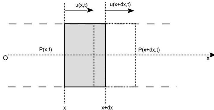
Fig 1.1 Modélisation d'une tranche cylindrique élémentaire
