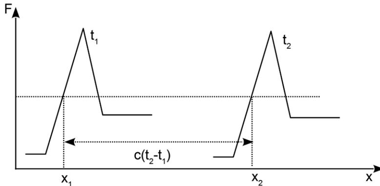
Fig 1.2 Propagation d'un signal entre deux instants
