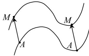
Dans ce cas,  $\frac{d(\overrightarrow{AM})}{dt} = \vec{0} \Rightarrow \overrightarrow{V_M} = \overrightarrow{V_A} \quad \forall (A, M) \in S$ . Tous les points de  $S$  ont même vitesse et même accélération et par comparaison avec la relation de Varignon, on a  $\boxed{\overrightarrow{\omega(t)} = \vec{0}}$ .
