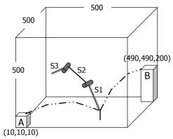
Un projet consiste à concevoir un bras articulé (3 segments S1, S2, S3) pour déplacer un objet de 1 kg, d'un point A à un point B (coordonnées connues), en respectant un volume enveloppe (cube 500x500x500).
