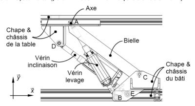
Le vérin articulé en A et en B permet de régler la table 7 en hauteur suivant y. Le vérin articulé en D et en E permet d'incliner la table 7 autour de l'axe z.
