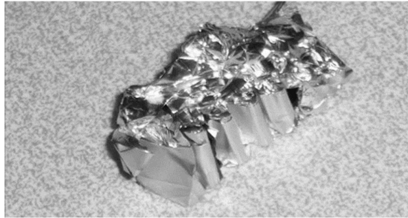
Figure 10 : La pièce est protégée et prête à être enrobée
